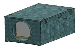
Os gabinetes de ventilação modelo GRB são compactos, utilizam construção com motor acoplado diretamente ao rotor, perfeito para aplicações com pouco espaço. A versão sem filtros é utilizada comumente como exaustor, enquanto as versões com filtros são utilizadas como insufladores. São construídos em chapa galvanizada, com vedação na tampa de acesso e com motores monofásicos. Além de silenciosos, possuem baixo consumo de energia, podendo ser instalados na vertical ou horizontal.
