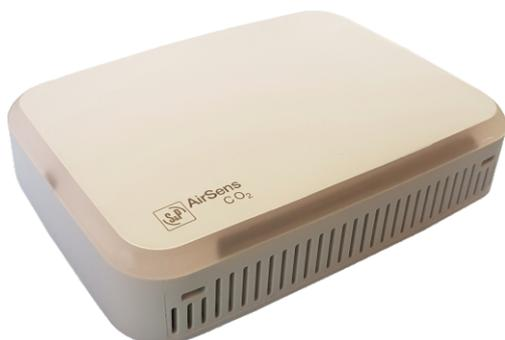
**E**lemento de controle de qualidade do ar interior que incorpora um sensor interno de CO2 ou VOC (compostos orgânicos voláteis) ou HR (umidade relativa). Especialmente projetado para criar sistemas DCV diretamente conectados com ventiladores monofásicos ou ECOWATT dependendo se é selecionada a saída de controle mediante relé ou sinal analógico.
