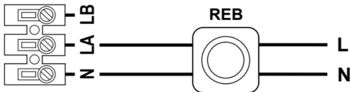
Funcionamento através de um regulador de velocidade variável.
