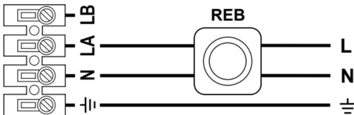
Funcionamento através de um regulador de velocidade variável.
