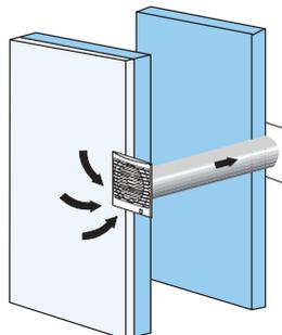
Saída através de parede dupla executada com acessório (DECOR-100).
