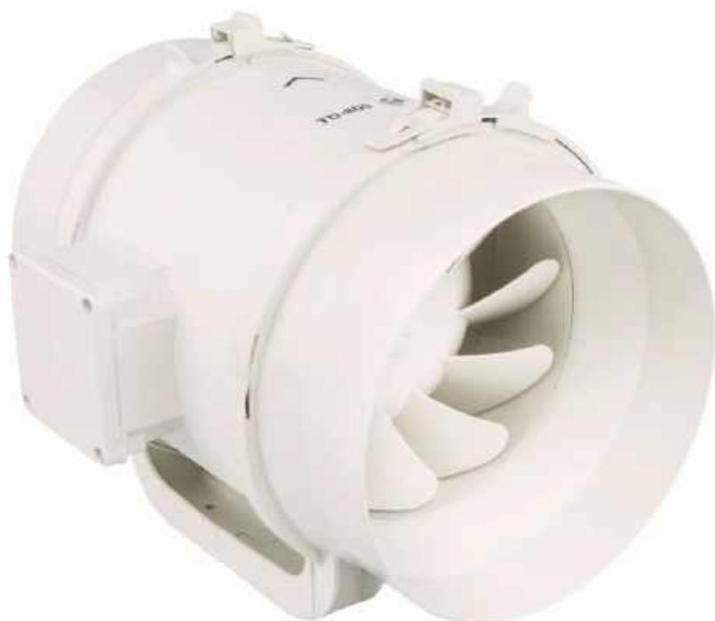
Ventiladores helicocentrífugos, de **baixo perfil**, fabricados em material plástico (até ao modelo 800), ou em **chapa de aço galvanizado**, protegida com pintura epoxi (do modelo 1000 em diante), com caixa de bornes externa, corpo motor desmontável e motor regulável 127V-60Hz ou 220V-60Hz, de duas velocidades **rolamentos de esferas** de lubrificação permanente e protetor térmico. Modelos TD-160 e TD-2000, Classe B, IP44. Modelos TD-4000 e TD-6000, Classe F, IP54.
