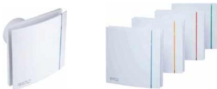
Ventiladores helicoidais de **baixo nível sonoro**, IP45, Classe II, vazão aproximada de 85 m<sup>3</sup>/h, comporta anti-retorno incorporada, luz piloto de funcionamento, motor 127V-60Hz ou 220V-60Hz com rolamentos de esferas, montados sobre silent-blocks, com protetor térmico, para trabalhar a temperaturas até 40°C.
