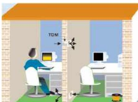
Os modelos 100 e 200 podem ser embutidos na parede, para transportar ar diretamente para o exterior ou trocar calor entre locais adjacentes.
