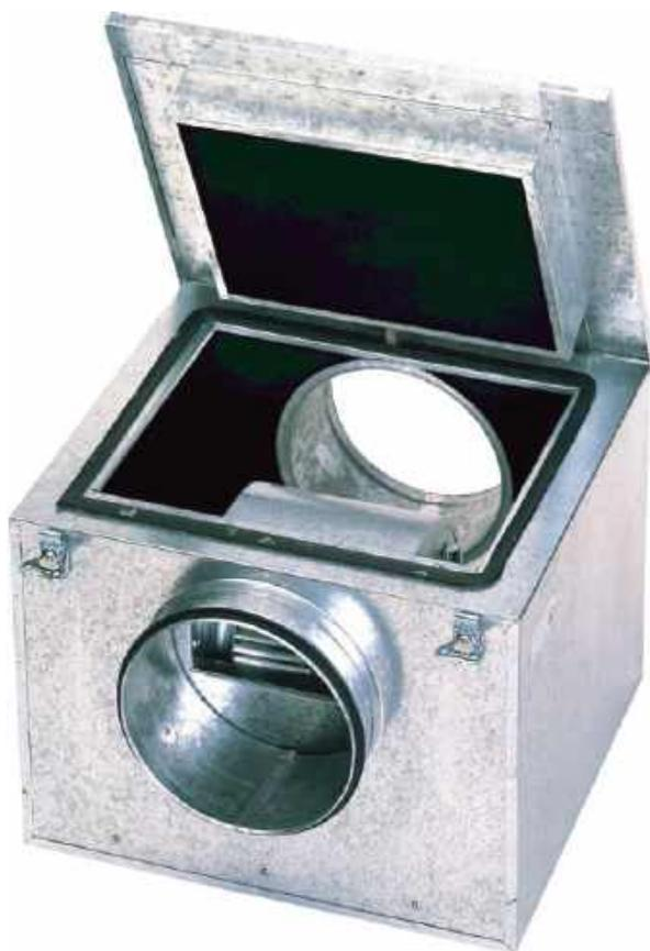
Caixas de ventilação estanques fabricadas em chapa de aço galvanizado, com isolamento acústico não inflamável (MO) de 50 mm de espessura, fechos estanques, de tipo tração giratória, de fácil abertura, ventilador centrífugo de aletas curvadas para a frente, motor IP44, Classe B (modelos 125 a 250) ou motor IP55, Classe F (modelo 315), com rolamentos de esferas, protetor térmico e caixa de bornes remota IP55. Podem ser instaladas no exterior sem necessidade de tampa de intempérie.
