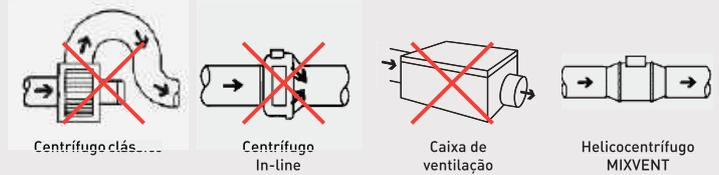
O baixo perfil dos ventiladores da gama TD MIXVENT faz com que seja a solução ideal para instalações onde a altura disponível é reduzida, como no caso de tetos falsos.
