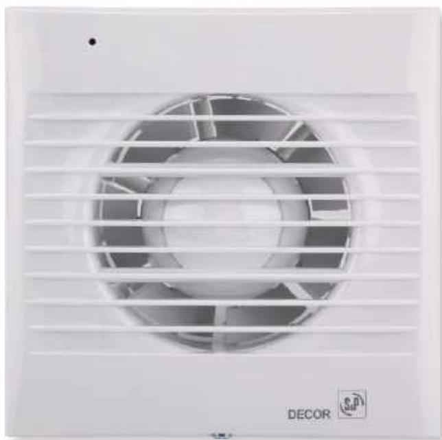
Ventiladores helicoidais extra-finos, IPX4, Classe II, com comporta anti-retorno incorporada, luz piloto de funcionamento, motor 127V-60Hz e 220V-60Hz, com protetor térmico, para trabalhar a temperaturas até 40°C. Dois tamanhos diferentes para dutos de 100 e 120 mm. Vazões aproximadas de 100 e 200 m<sup>3</sup>/h, respectivamente, em descarga livre.
